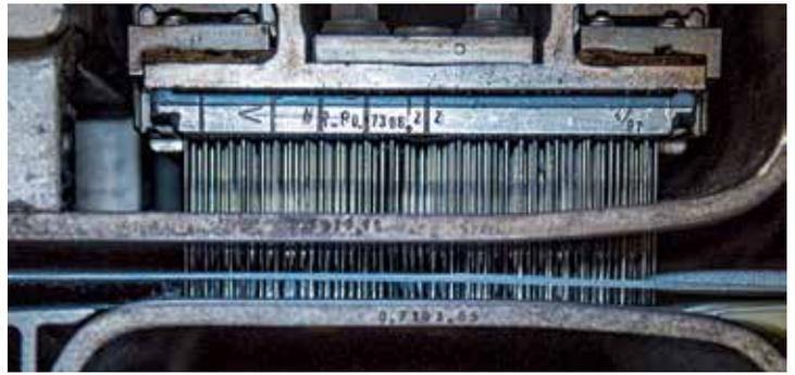
Bei der Vernadelung erfolgt die Verfestigung des Vlieses mechanisch durch sich vertikal bewegende Widerhakennadeln.
