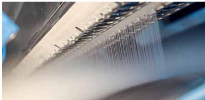
Beim Wasserstrahlverfahren wird der Faserflor mit Hilfe von Wasserstrahlen bei hohem Druck so verfestigt, dass ein homogenes textiles Gewebe entsteht. Mit dem Verfahren können reine Naturfasern, zum Beispiel Lyocell oder Viskose, verarbeitet werden, ohne dass synthetische Fasern beigemischt werden müssen.
